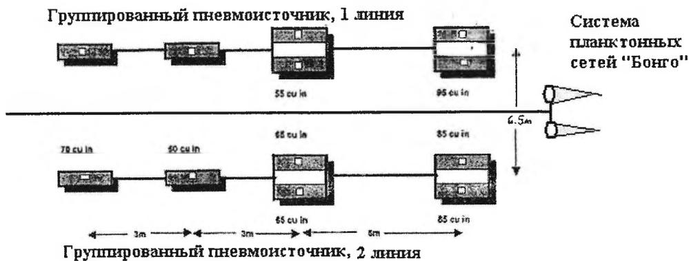
Рис. 2. Схема расположения планктонных сетей «Бонго» относительно буксируемого группированного пневмоисточника, состоящего из двух линий
